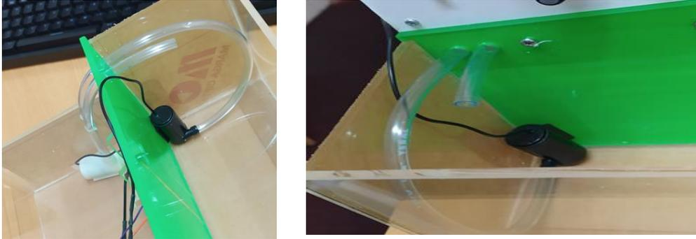
Gambar 14. Simulasi pintu air menggunakan sistem valve otomatis dan sistem elektronik (a), dengan bagian kontrol panel (b), sensor ketinggian (c), pintu air (d), box biochar (e) dan pompa (f)
