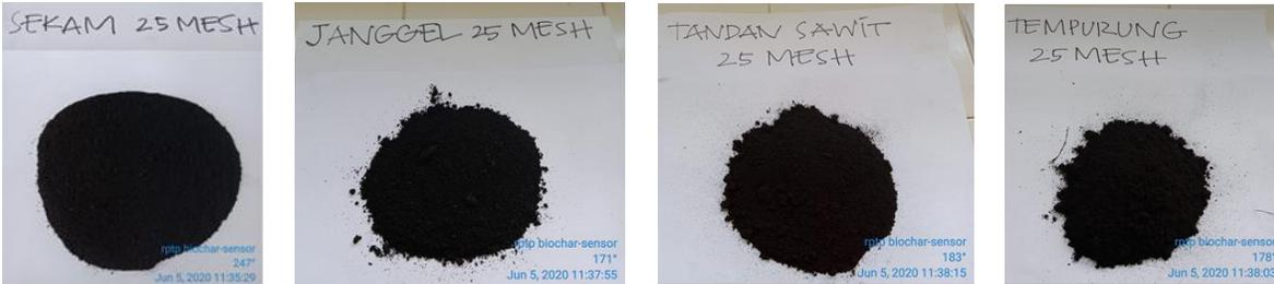
Gambar 9. Empat jenis biochar yang diproses pada suhu pirolisis 350-400°C dengan ukuran partikel 25 mesh
