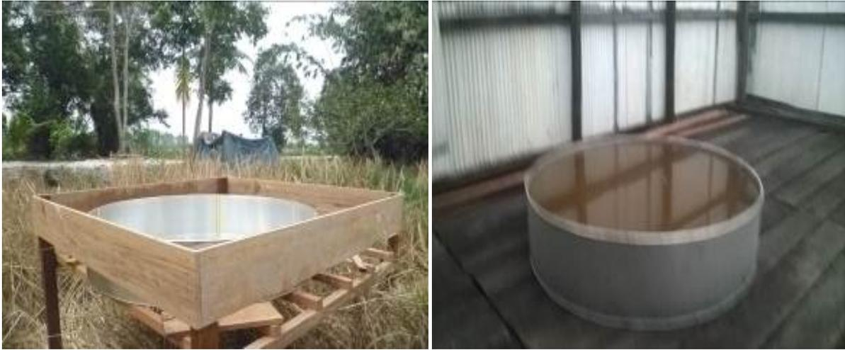
Gambar 29. Pan evaporasi yang di pasang di UPT Terantang dan KP. Alabio
